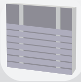
Pose horizontale simple lambourde
