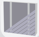
Pose diagonale simple lambourde
